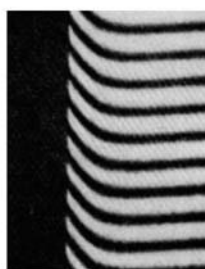
Fig. 3. Interferenzbild bei Stromdurchgang (0,37 mA/cm 2 ). Vergrößerung: 23×
